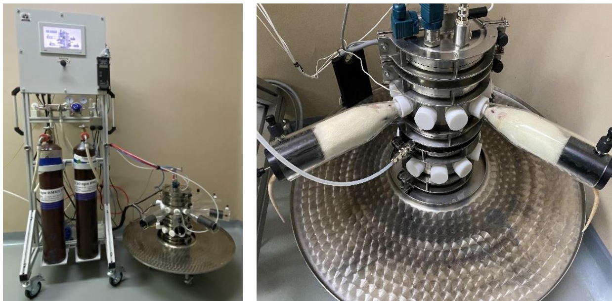
Рисунок 2.2. Лабораторный ингаляционный комплекс для подачи газовых смесей
